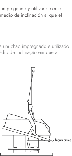
Diagrama de un péndulo utilizado para medir la resistencia al deslizamiento.
